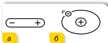
Мал. 252. Види діелектриків: а — полярні; б — неполярні
