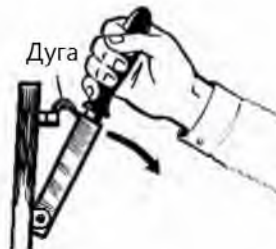
Рис. 3.7. Приклад виникнення самоіндукції (дуги)
