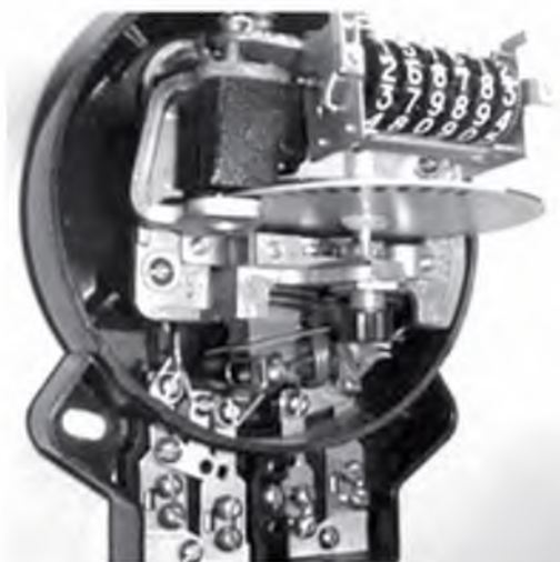
Рис. 9.12. Зовнішній вигляд індукційного лічильника (без кришки)
