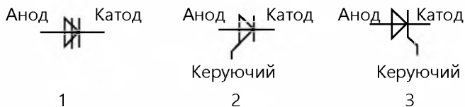
Рис. 10.19. Умовні графічні позначення тиристорів: 1 – диністор; 2 – триністор із керуванням за анодом; 3 – триністор із керуванням за катодом
