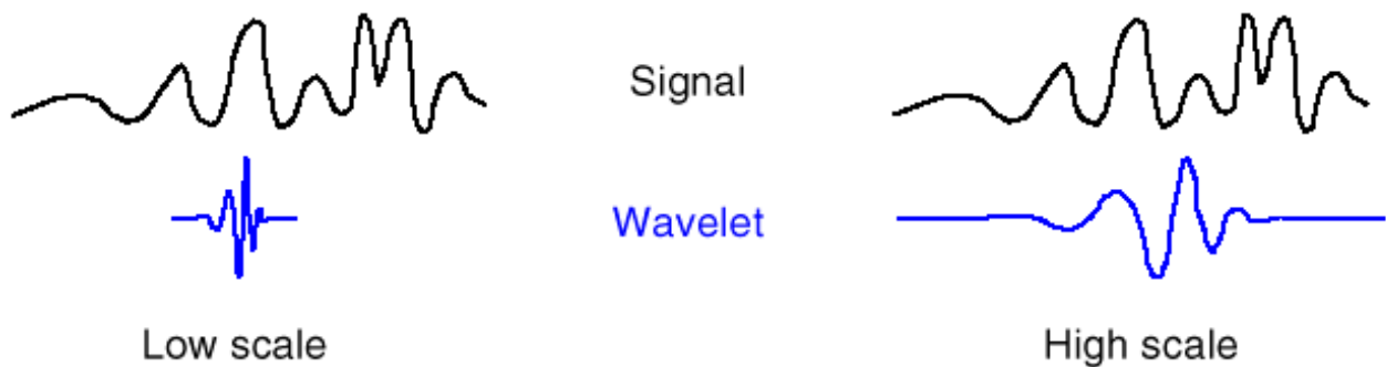
Рисунок 1.15 – Зв'язок між масштабом вейвлету та частотою складових сигналу
