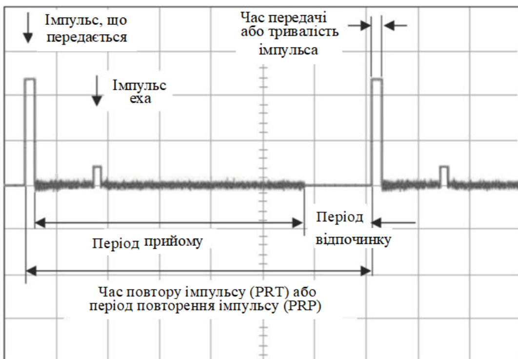
Рисунок 6.10 – Тимчасові етапи періодів роботи найпростішого радару
