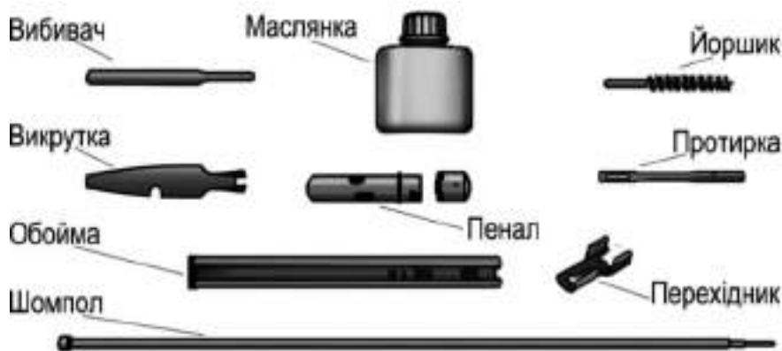
Лл. 18.3. Приладдя для чищення автомата Калашнікова
