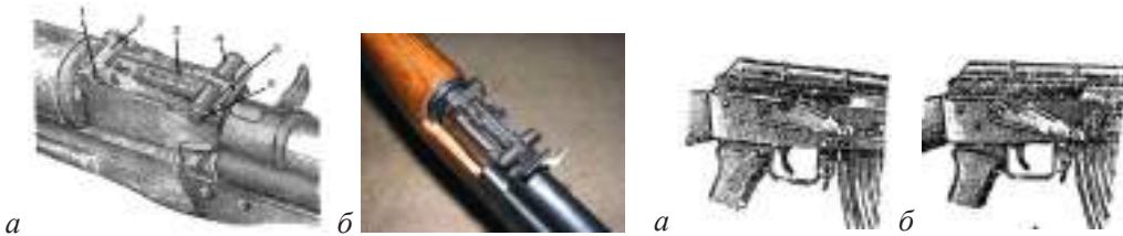
Іл. 16.4. Установка прицілу. Прицільний пристрій: 1 — колодка прицілу; 2 — пластинчаста пружина; 3 — прицільна планка; 4 — хомутик; 5 — полозок з мушкою; 6 — запобіжник мушки
